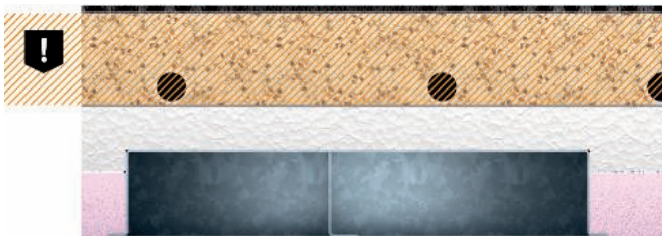
Espessura nominal da betonilha para calhas de pavimento EÜK
