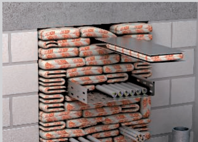
Chapas para auxílio de montagem para a última camada de almofadas.
