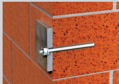
Montar o perno de ancoragem em tijolos bem cozidos sem bucha perfurada.
