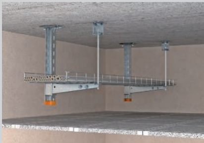
Suspensão no teto de uma camada com pendural e consola.
