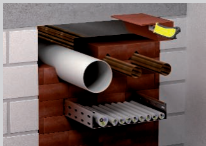
Utilização de tubos inflamáveis sem medidas adicionais.
