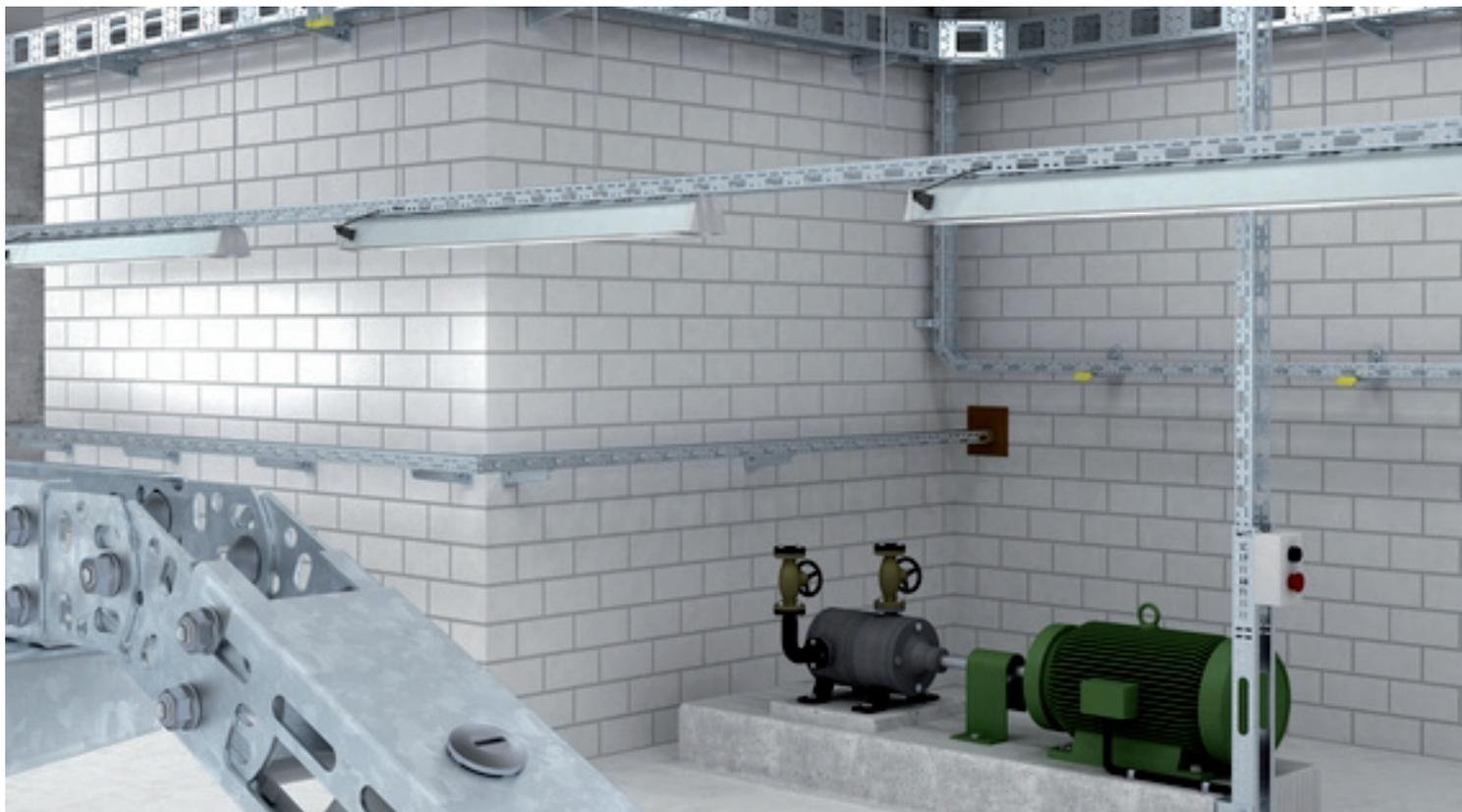
A Eletrocalha AZ possui furações na base e nas laterais, facilitando a saída dos cabos para a instalação de luminárias, botoeiras de comando, bem como realizar a alimentação elétrica de prensas, máquinas, motores, etc. Fabricada em chapa de aço de 1,5 mm de espessura, é resistente e suporta alta capacidade de carga. Com o ANEL KSR instalado nas furações, pode-se fazer a saída dos cabos de forma segura pela lateral ou pela parte inferior da eletrocalha.
